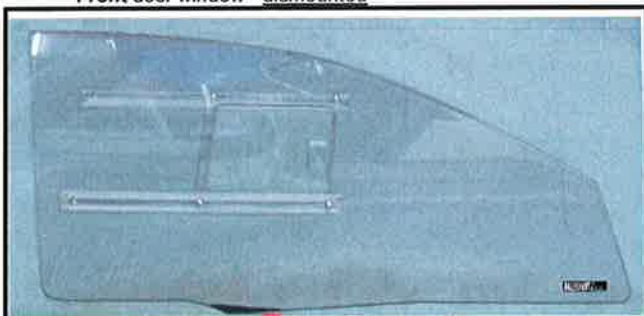
M7-5) Vitre de porte avant - déposée Front door window - dismantled
