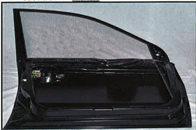
M7-1) Porte avant nue – face intérieure Bare front door – inner face
